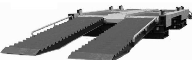
○ダブルタイヤの間に入り込んだ泥土も落とせます。
