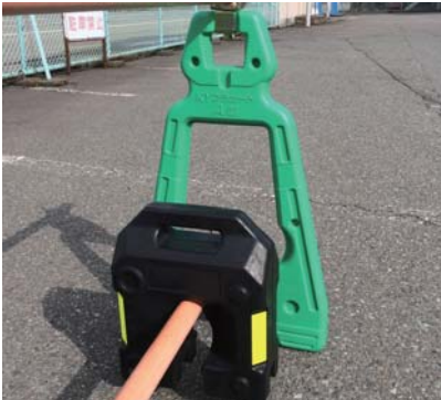
単管バリケード設置例
